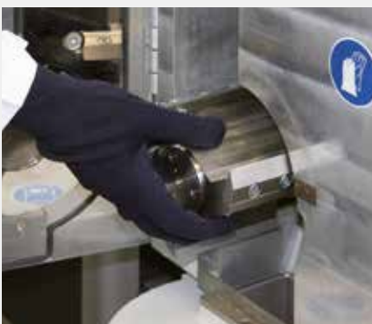
Rotores de quita y pon para una limpieza fácil
